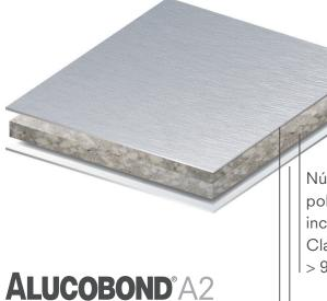
Núcleo relleno de minerales con polímero adhesivos, incombustibles Clase A2-s1, d0 > 90% de contenido mineral
