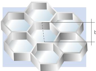
**Сотовая сердцевина** состоит из алюминиевой легированной фольги AIMn (EN AW 3003). Размер ячеек (b): 9,5 мм. **Покрывающие листы** панелей ALUCORE® выполнены из антикоррозионного сплава Peraluman (AlMg) и изготавливаются в соответствии со сферой применения – декоративно-отделочной или конструктивной.
