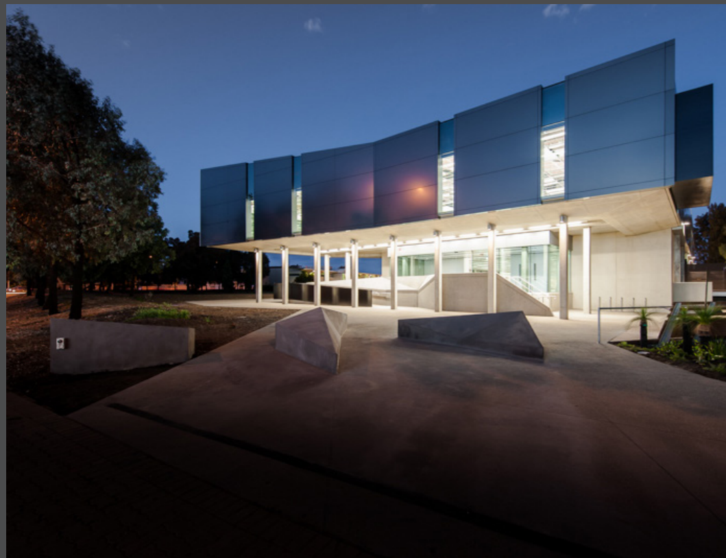
Protective bollards serve as casual seating benches. | Schutzpoller dienen als zwanglose Sitzgelegenheiten.
