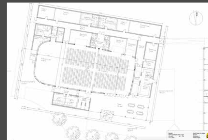
The shape of the floor plan also indicates the two-part division between side rooms and hall: one is linear; the other freeform. Auch im Grundriss ist die Zweiteilung in Serviceräume und Saal anhand der Form erkennbar: gradlinig das Eine und frei geformt das Andere.
