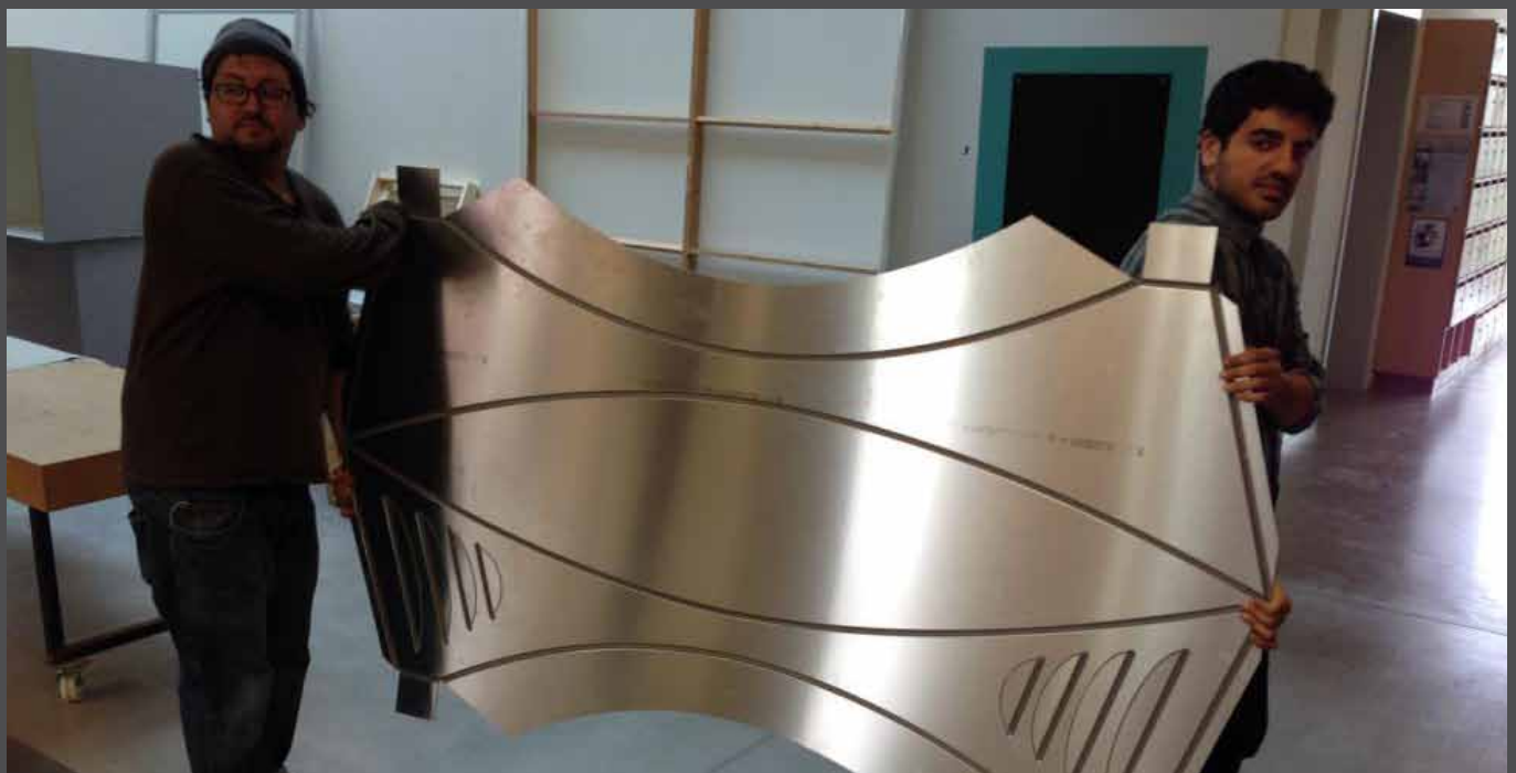
The final panel after routing. Die finale Platte nach dem Fräsen.
