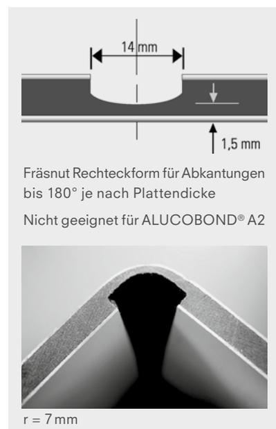
**Hinweis:** Bei ALUCOBOND® mit eloxierter Oberfläche und bei ALUCOBOND® mit naturAL Reflect Oberfläche entstehen an den Kanten Aufhellungen durch Microrisse.
